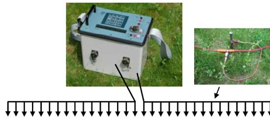
Figure 1 : SYSCAL Switch multi-electrode equipement
