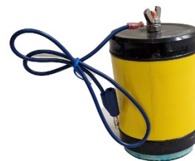
Electrode impolarisable Cu - CuSO_4 500 g – 13 cm – 8 cm (diamètre)
