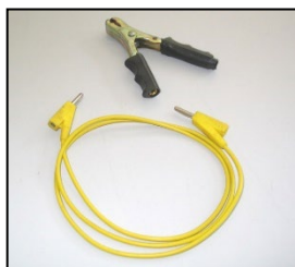
Câble avec pince pour connexion bobine à une électrode
