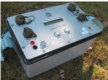
Boîtier d'extension Switch Pro capable de gérer 24 - 48 - 72 et jusqu'à 96 électrodes
