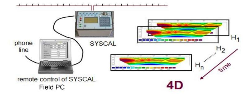
**Contrôle à distance du résistivimètre : Logiciel COMSYS Pro**
